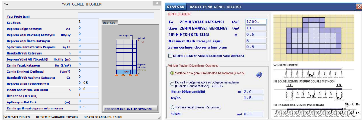
Şekil 1. Sta4Cad yapı ve radye plak genel bilgileri ekranı
